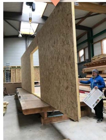
Fabrique de l'ossature en atelier
